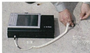
弾性波レーダーによるコンクリート検査
